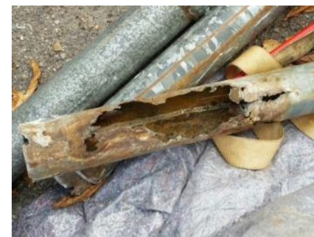
Eksempel på ca. 20 år gammel galvaniseret køkkenfaldstamme. Fotoet er ikke fra jeres bygning
